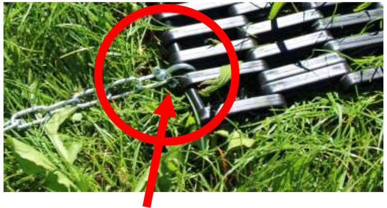
Der beiliegende Schäkel mit Kette wird zwischen den Mattengliedern eingehängt (Der Schraubenkopf des Schäkelbolzens muss in Richtung Bodeneingehängt werden. Bild zeigt die falsche Montage des Schäfels).
