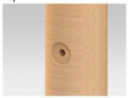
Zuerst den Pfosten mit einer Bohrung Ø 22 mm durch bohren. Danach eine Senkung (um die Durchgangsbohrung herum) mit Ø 60 mm mindestens 10 mm tief senken. Auch die gegenüberliegende Seite wird genauso gesenkt. 2)
